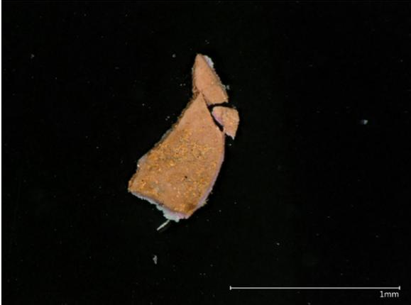
Abb. 23 P1\_orange\_Malschicht\_Zusammensetzung
